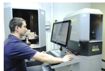
Uwe Schenn, responsable de production, lors d'une mesure d'outil sur le banc universel »genius«
