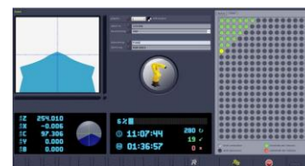
Ready – robo – go: mesure complète automatique, marquage et enregistrement en une opération
