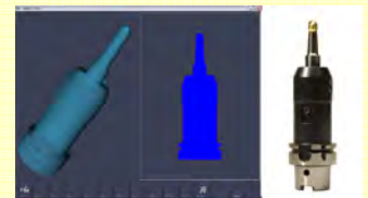
Bild 1 ZOLLER »3D-Scan« zur Kollisionsprüfung und Erstellung eines Werkzeugkatalogs
