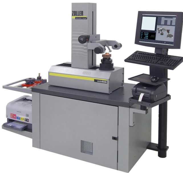
Bild 1: Das ZOLLER »smile EDM«: Messen von Elektroden und Werkzeugen auf einem universellen Messgerät
