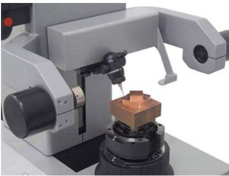
Bild 3: Der Messtaster zum Messen des Mittensversatzes in X und Y, Versatzwinkels und der Länge an Elektroden
