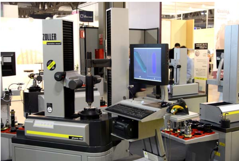
Bild 4: Das ZOLLER »phoenix«: \mu -genaues Einstellen und Messen von Reibahlen.
