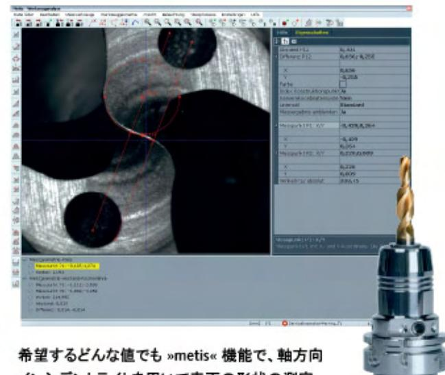
希望するどんな値でも »metis« 機能で、軸方向インシデントライトを用いて表面の形状の測定
