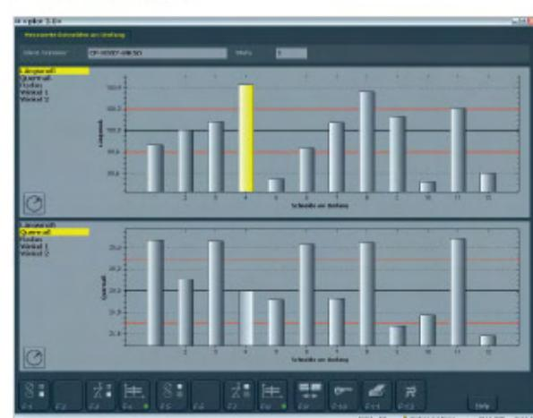
複数刃のスローアウェイチップカッター(鋸刃、ミーリングヘッド)用自動刃先補正機能付き、刃先の同心度と振れ精度の画像評価
