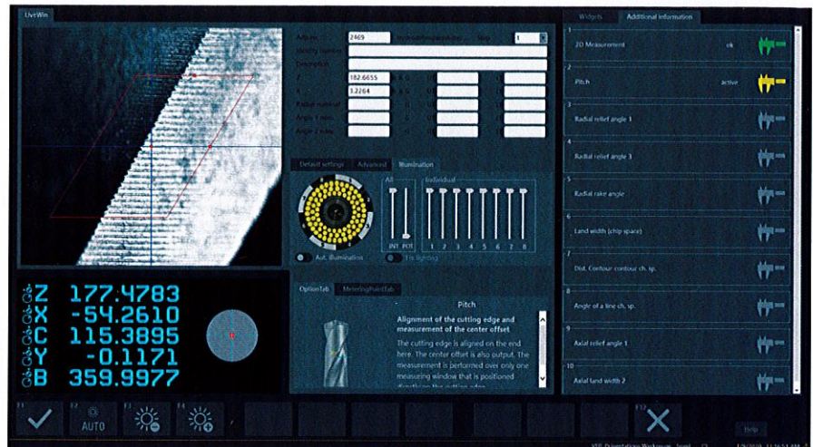
Bild 3: Abhaken, loslegen: zu vermessende Parameter werden schnell und einfach in der selbsterklärenden Software-Oberfläche ausgewählt und »genius« übernimmt die Vermessung – vollautomatisch
