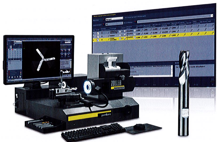
Bild 4: Das kompakte Inspektionsgerät »pomBasic« (Bilder: E. Zoller GmbH & Co. KG, Pleidelsheim)
