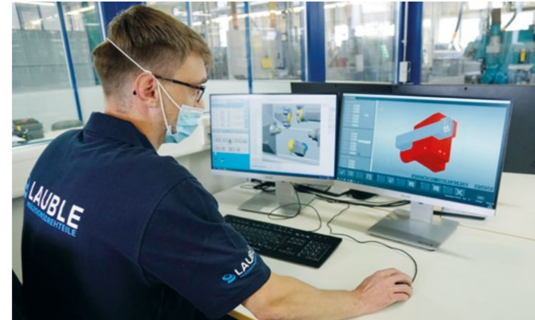
Die 3D-Werkzeugdaten in der ZOLLER-TMS-Software entsprechen den tatsächlich vorhandenen realen Werkzeugen.
